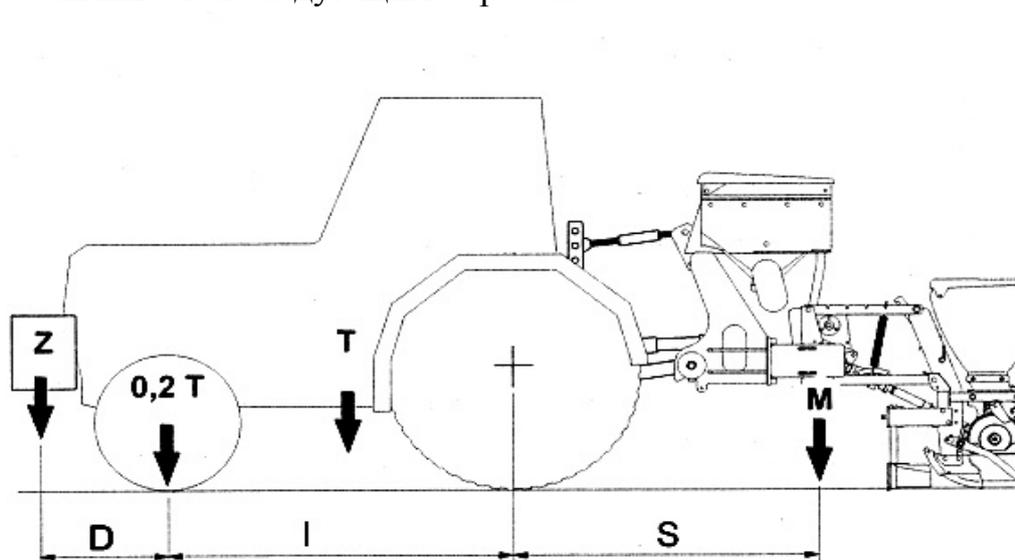
Рис.2 Схема распределения масс агрегата сеялка-трактор.
