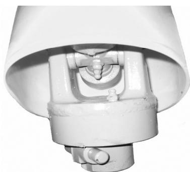
При установке необходимо контролировать, чтобы фиксатор шлицевого соединения на кардане совпал с пазом на ВОМ и на валу сеялки. После установки карданного вала необходимо убедиться в том, что его защитный кожух вращается свободно. После чего зафиксируйте его, перекинув через центральный винт (поз.3 Рис.5) цепь кожуха.
