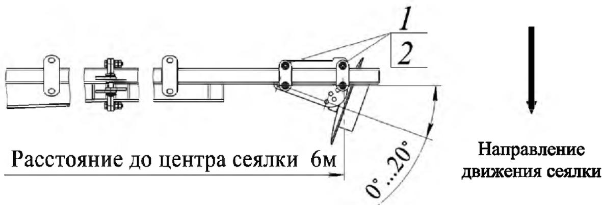
Рисунок 2215. Установка угла атаки маркёра (левый маркёр).
