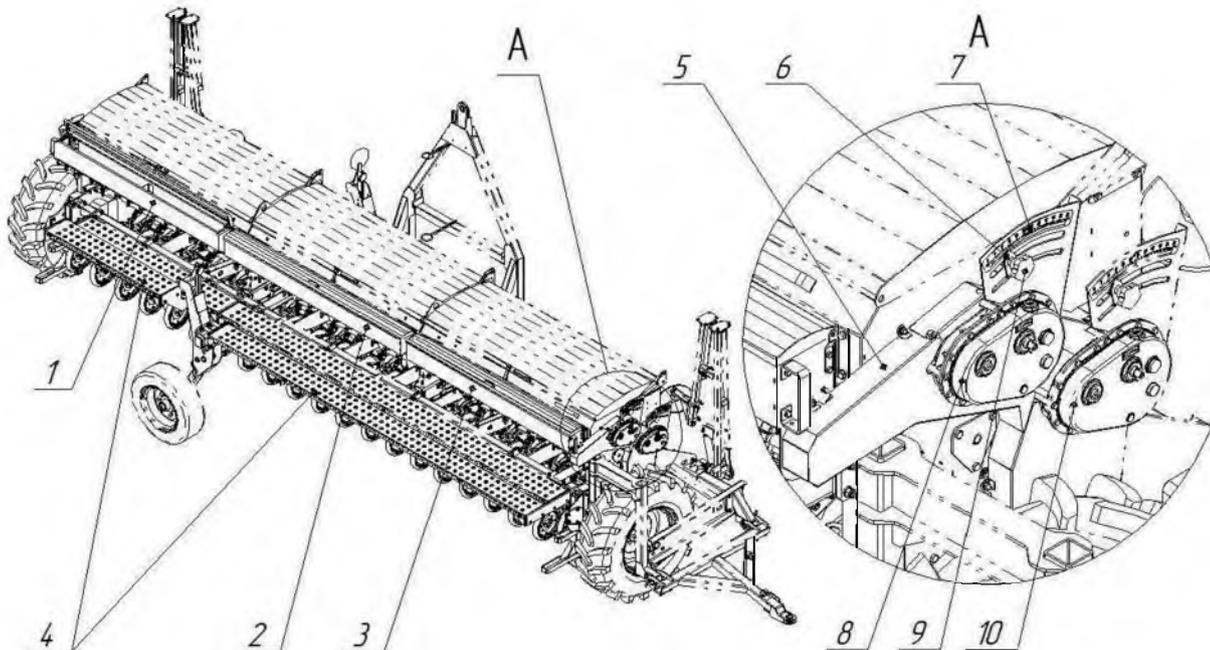
Рисунок 148. Приспособление для высева семян трав.
