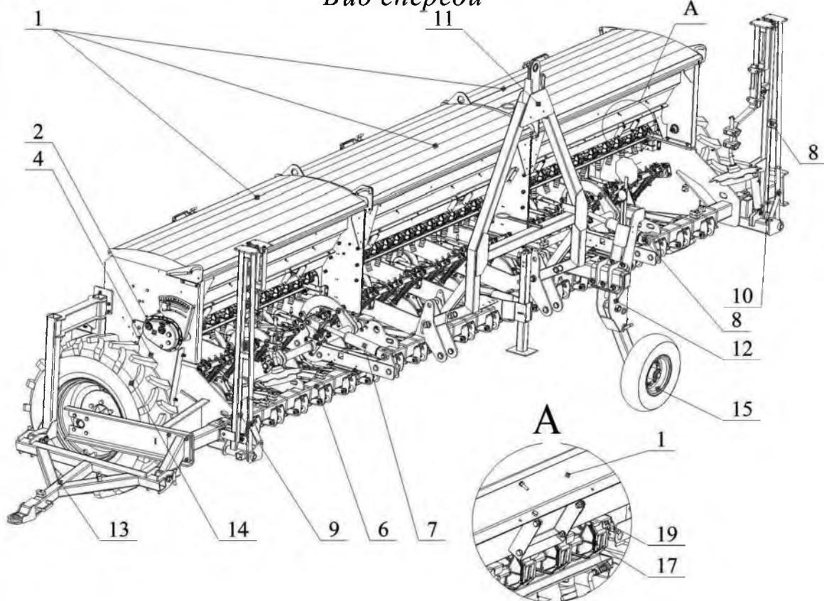
**Рисунок 1. Общий вид сеялки ЗС-6**
