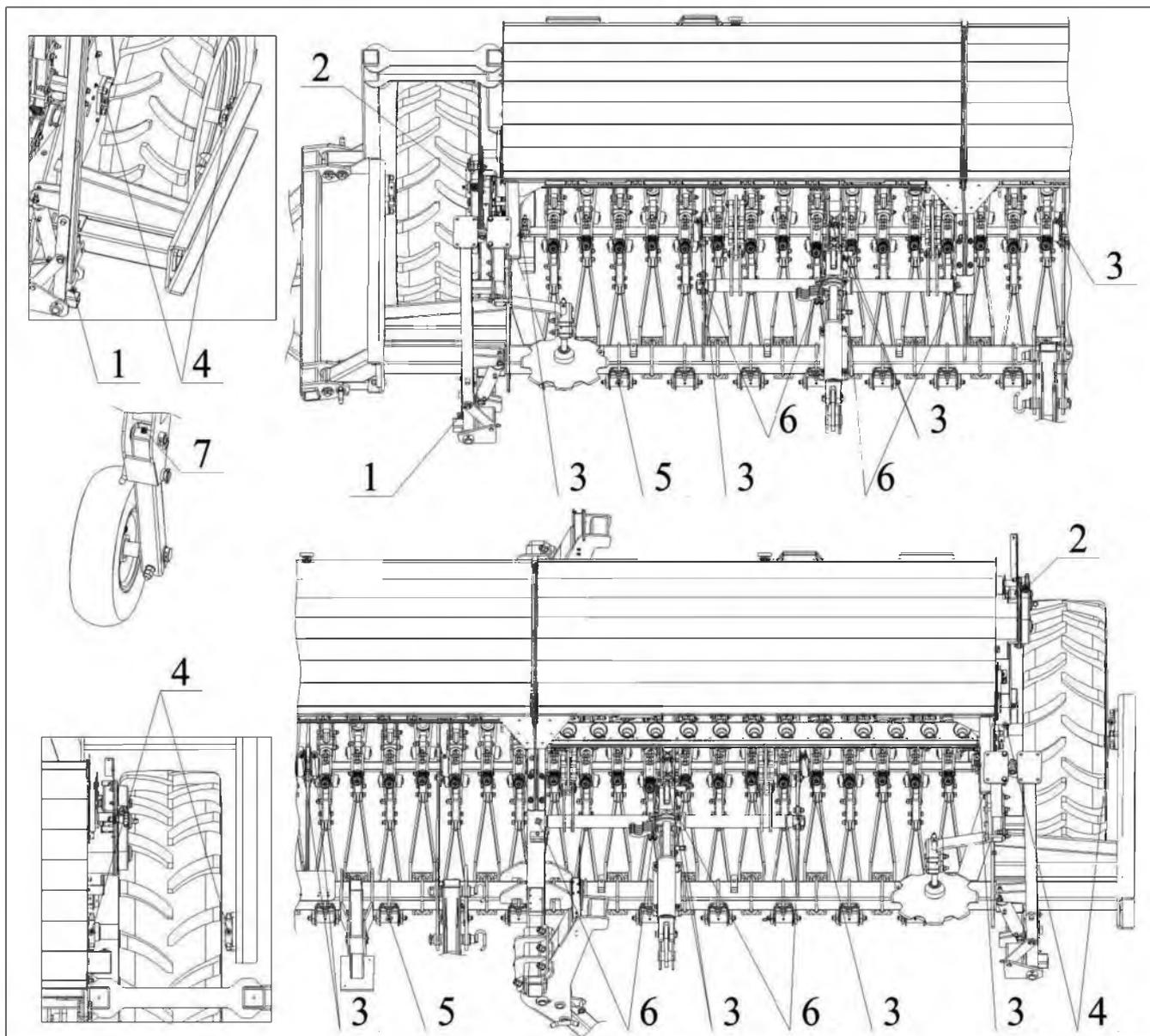
Рисунок 28. Расположение обслуживаемых точек внесения смазки
