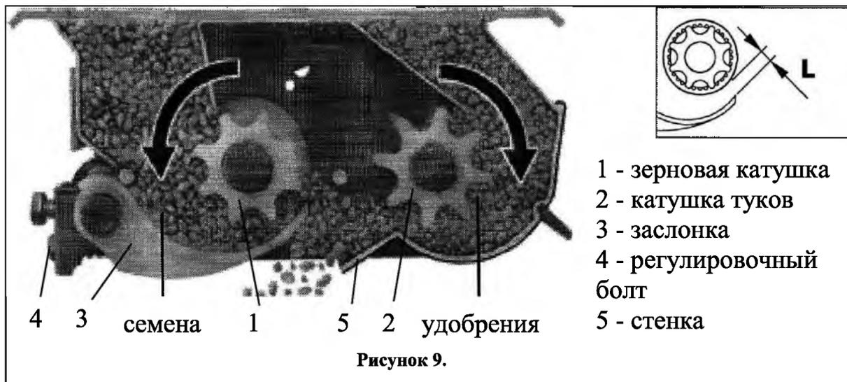
Регулировка высевających аппаратов проводится в соответствии с данными таблицы 2, в зависимости от высеваемой культуры.
