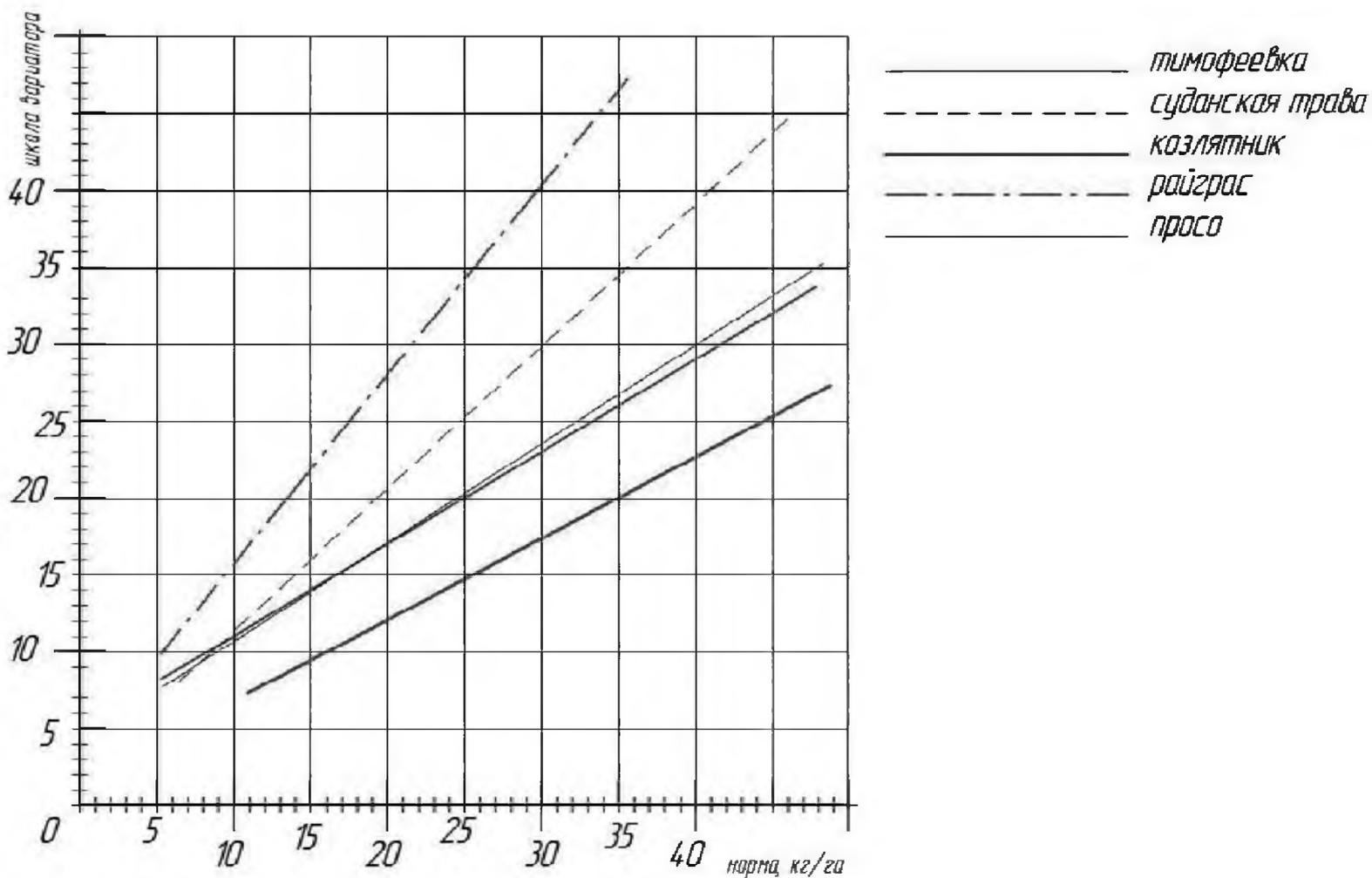
Рисунок 12. График нормы высева семян трав основными высевающими аппаратами.
