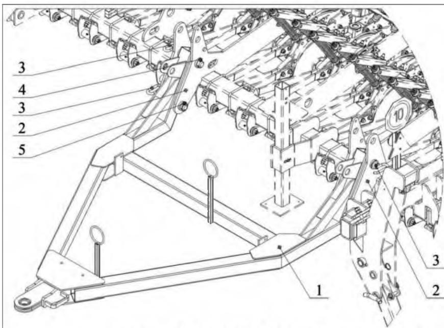
Рисунок 2. Дышло в сборе, установленное на раме.
