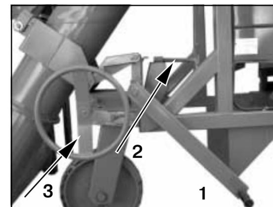
**6.2.** Гайкой 1 (рис.6) растормозите вращение отгрузочного транспортера 2, разверните его в нужном направлении, зафиксируйте.
