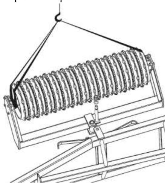
Рис.6 Установка секции катка с помощью подъемного механизма
