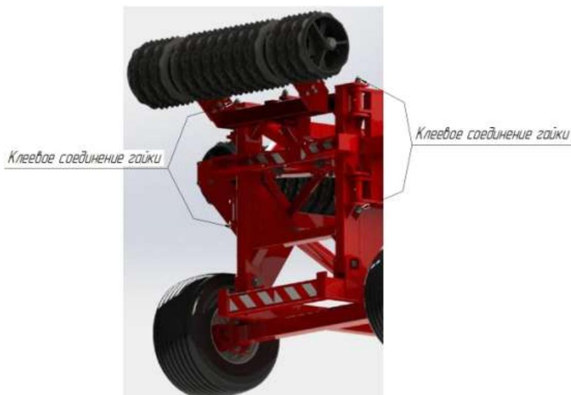
Рис. 8 Места крепления резьбовых соединений с помощью клея
