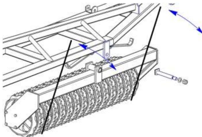
Рис.7 Установка секции катка с помощью ручных приспособлений
