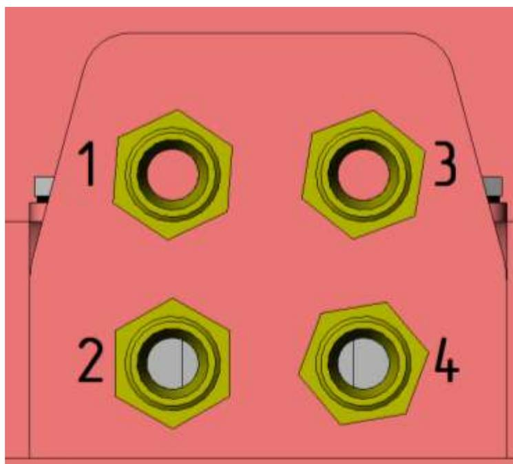
Рис. 10 Схема подключения гидравлических шлангов к катку
